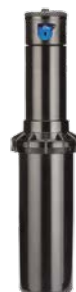
PGP-04 Altura total: 19 cm Altura de elevação: 10 cm Diâmetro exposto: 4,5 cm Tamanho da rosca: ¾" fêmea NPT
